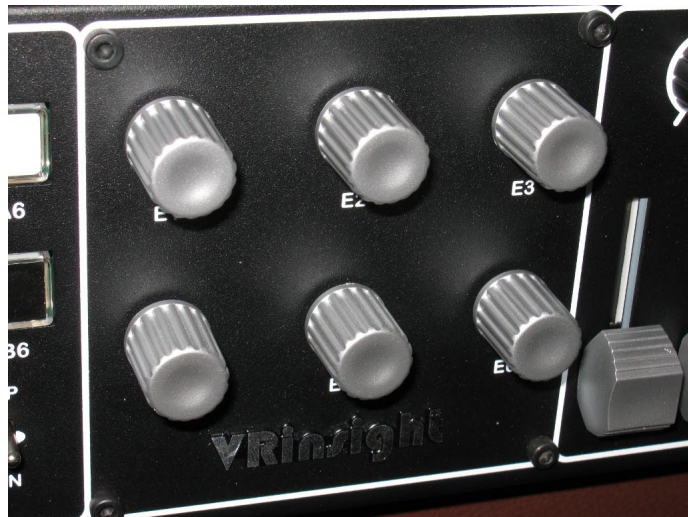
Fot. 2. Panel posiada 6 enkoderów
