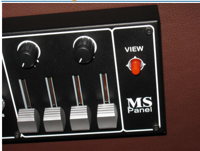
Fot. 3. Pokręta i suwaki są identyfikowane jako osie
