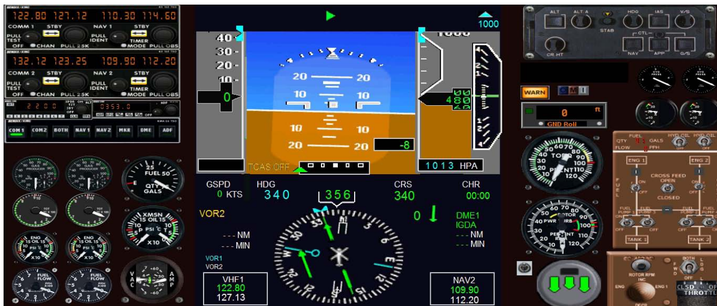
Rys. 7. Zmodyfikowany panel Agusty A109 z glass cockpit od A139 oraz autopilotem
