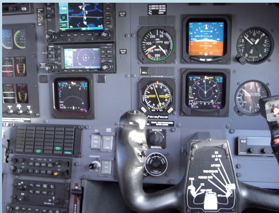
Fot. 6. Przejrzyście zaprojektowany kokpit, EFIS, możliwość instalacji FMC, zaawansowany autopilot. Wszystko to zwiększa komfort pilotowania PC-12.
